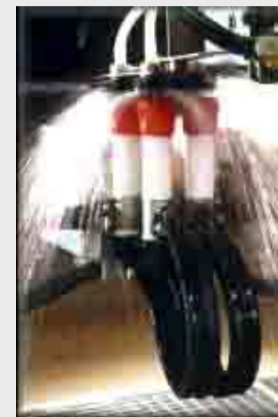
Obr. č.24: Proplach strukových násadců
