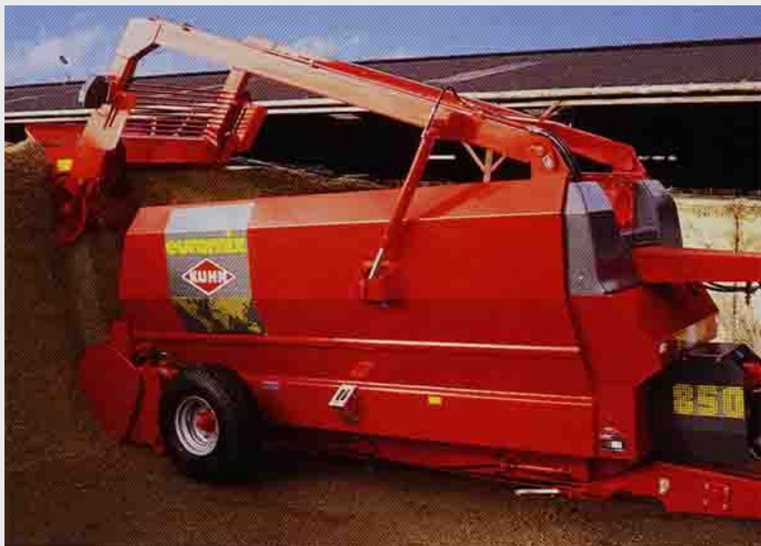
Obr. č.47: Plnění míchacího krmného vozů rotační frézou
