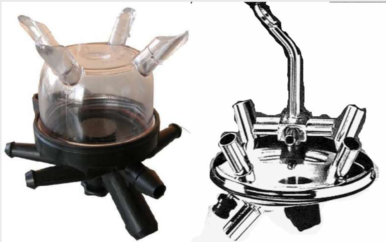
Obr. č.9: Rozdělovač a sběrač v dojící soustavě
