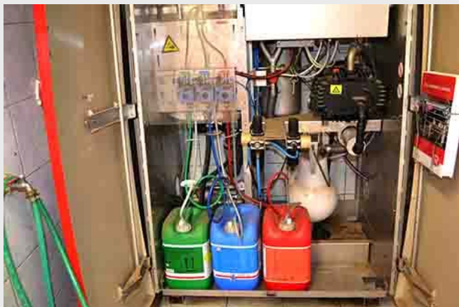
Obr. č.23: Strojovna dojícího robota s vývěvou a desinfekčními přípravky
