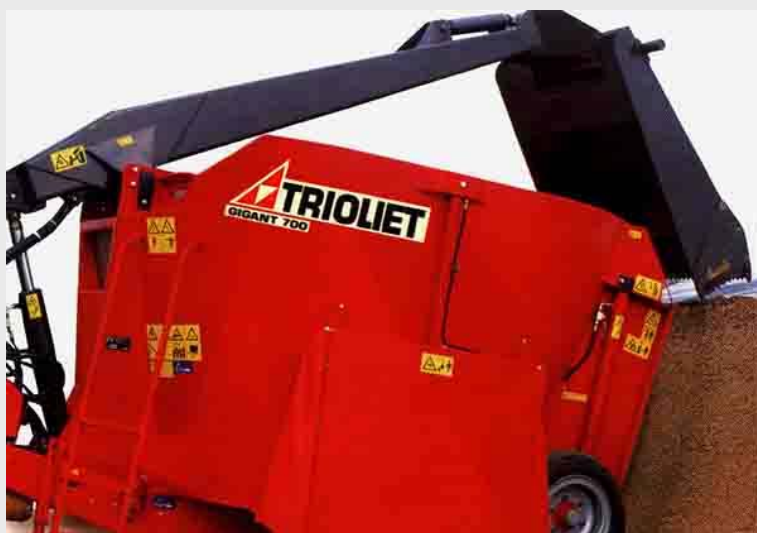
Obr. č.49: Plnění hydraulickou rukou s odřezávacím štítem
