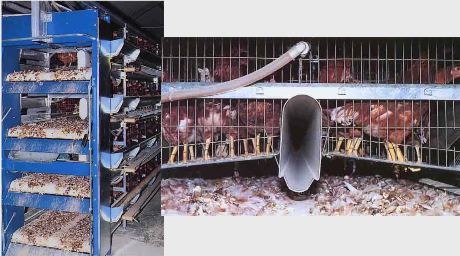
Obr. č.20: Odstranění trusu pomocí trusového dopravníku
