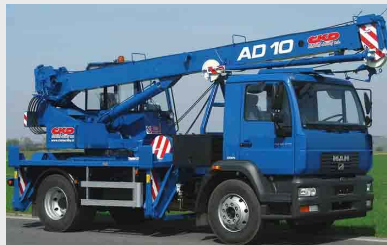
Obr. č.56 Autojeřáb Man AD 10
