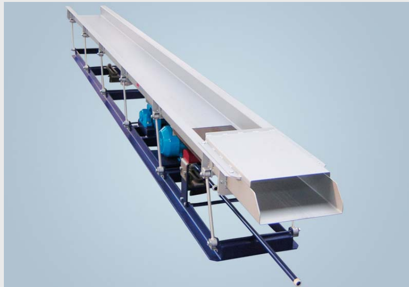
Obr. č.39 Vibrační dopravník s budičem kmitů
