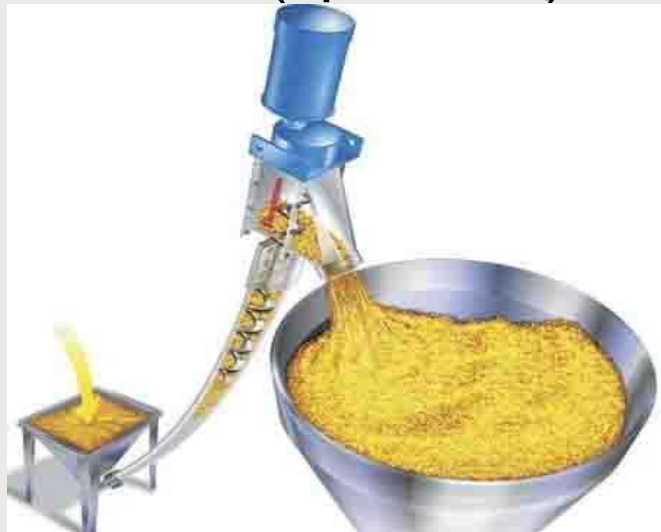
Obr. č.18 Ohebný šnekový dopravník bez hřídele
