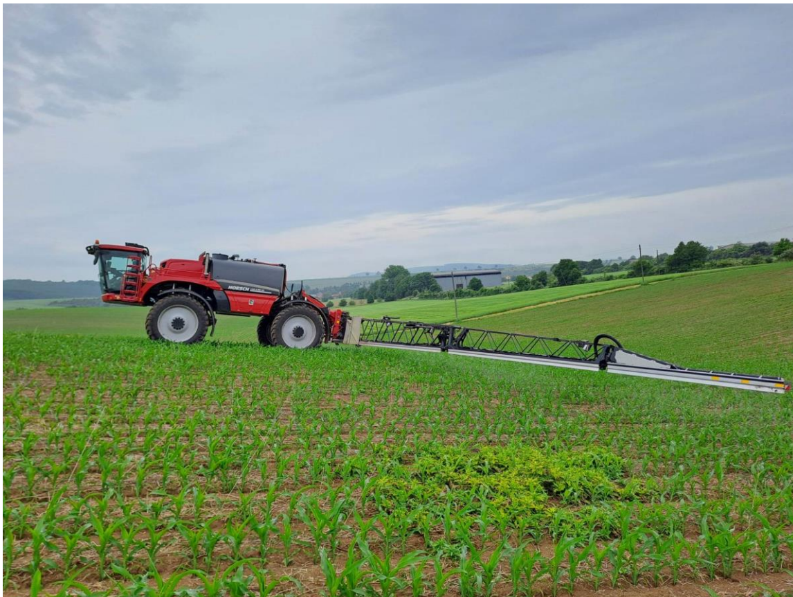
Obr. 17 Provedení plošně diferencované aplikace herbicidních látek postřikovačem Horsch Leeb na pozemcích ROSTĚNICE a.s.
