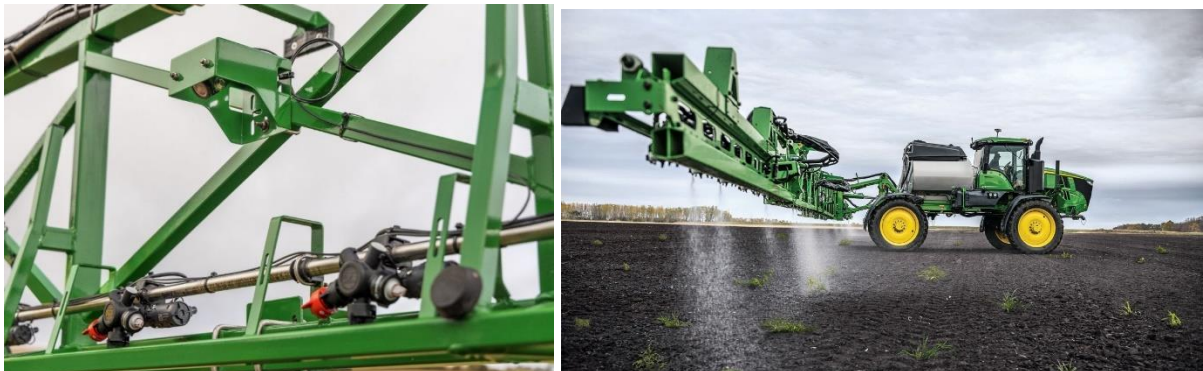
Obr. 1 Sensorový systém John Deere See&Spray umožňuje v reálném čase snímat povrch půdy, vyhodnotit zaplevelení a ovládat jednotlivé aplikační trysky postřikovače ( https://www.deere.com/en/sprayers/see-spray-ultimate/ ).
