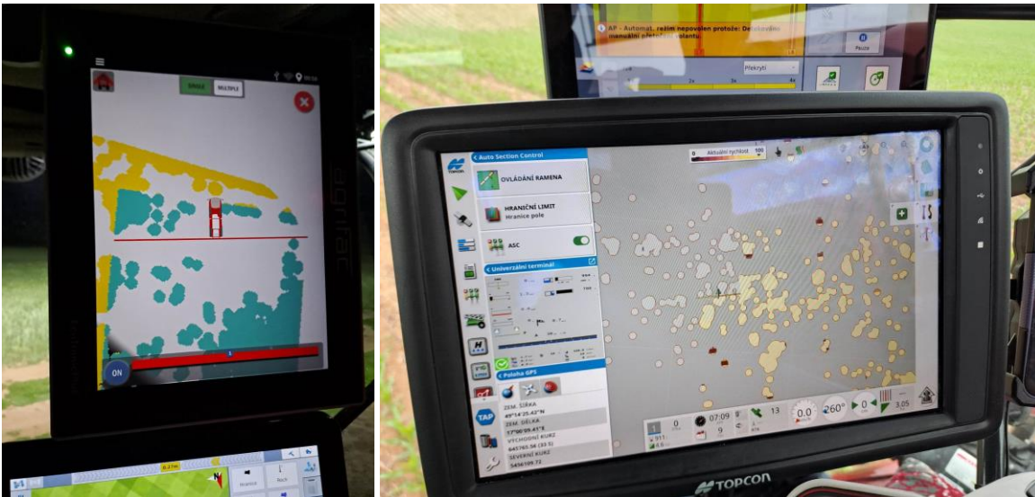
Obr. 16 Aplikační mapy nahrané do palubního terminálu postřikovače Agrifac (vlevo) a Horsch (vpravo)
