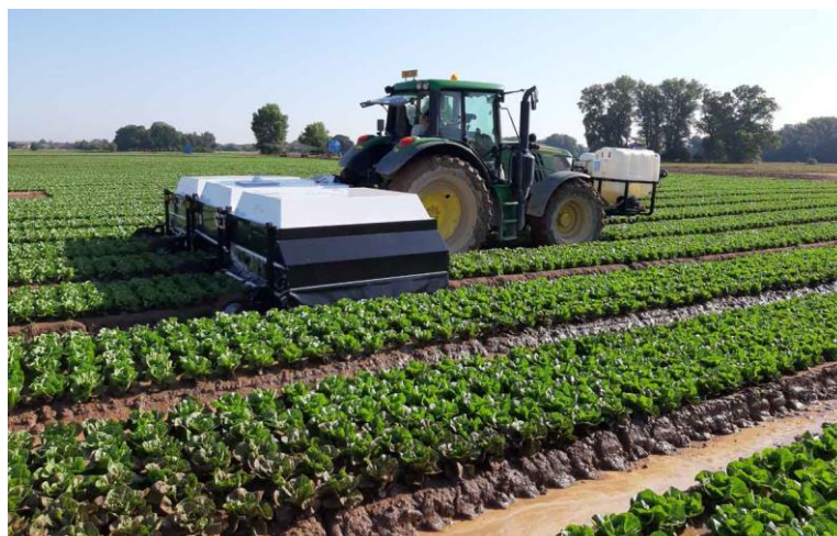
Obr. 2 Nesený postřikovač Ecorobotix ARA pro přesnou cílenou aplikaci postřikových látek (Zdroj: www.leadingfarmers.com )
