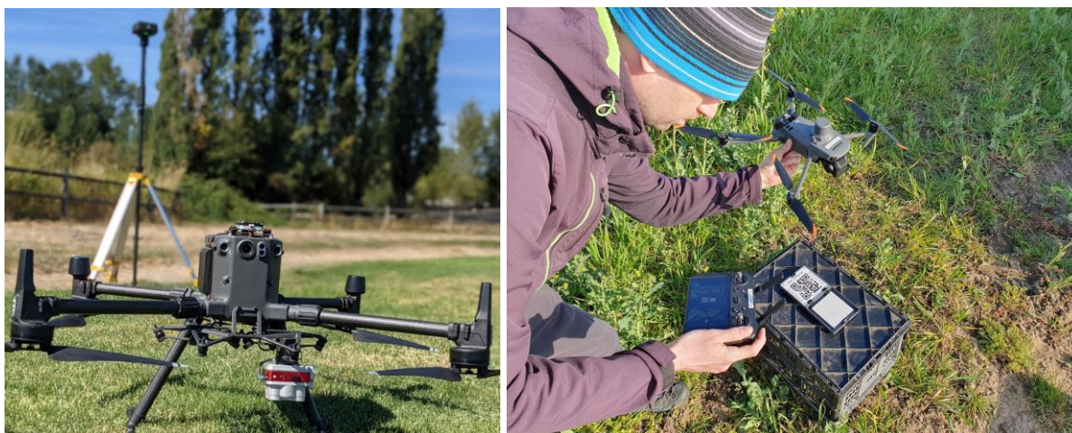
Obr. 4 DJI Matrice M300 osazený kamerou Micasense Altum (vlevo, zdroj: www.micasense.com ) a radiometrická kalibrace Mavic 3 Multispectral s využitím panelu Micasense CRP06.
