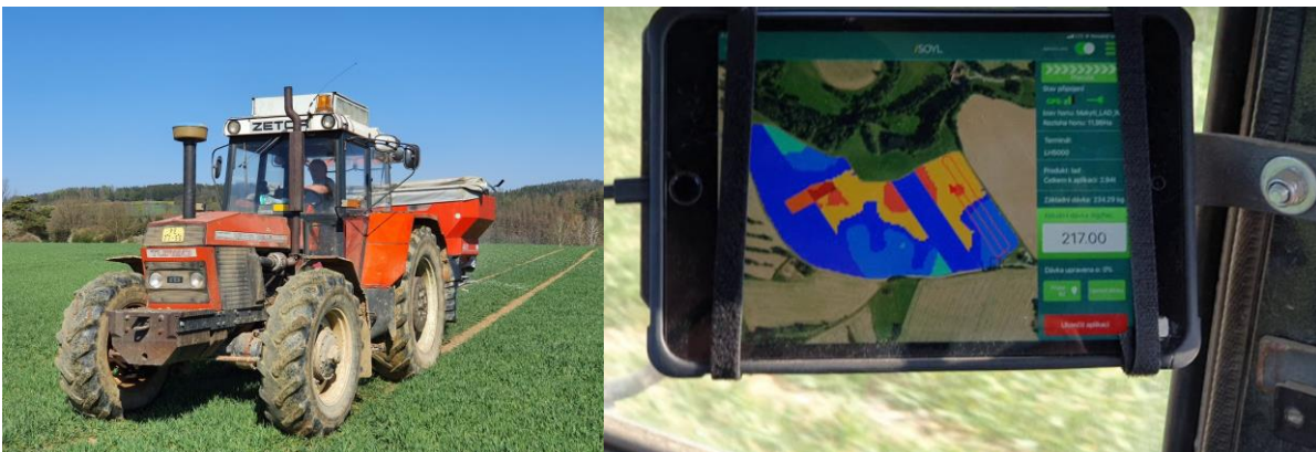
Obr. 16 Fotodokumentace variabilní aplikace řízené pomocí iSoyl na PB5 „Makytí“ v roce 2020 – tablet s nahanou aplikační mapou posílá informaci o dávce do palubního počítače rozmetadla Rauch.
