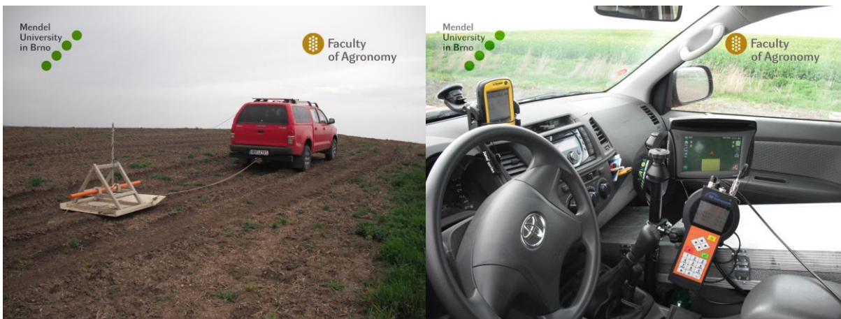
Obr. 4 Příklad měření elektromagnetické indukce půdy – měřicí souprava GF Instruments CMD–MiniExplorer 6L a pohled do kabiny
