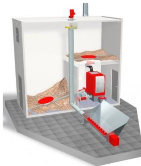
Obr. 3 Řez dvoupatrovým topným kontejnerem
