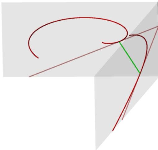
Nejčastější aplikací těchto ploch je určení přechodové plochy mezi dvěma danými potrubími. Určujícími křivkami mohou být dvě kružnice, kružnice a elipsa, nebo například i kružnice a čtverec.
