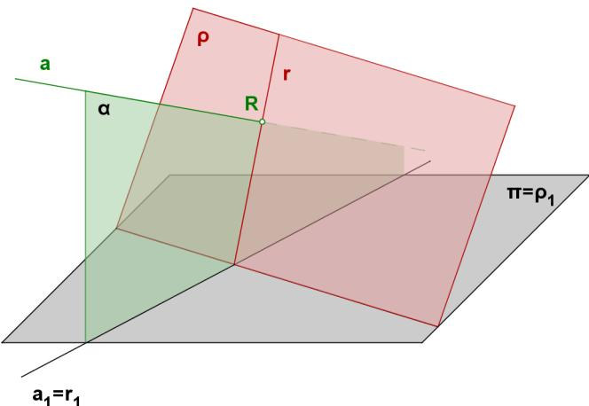
V nákresně nelze určit průsečík přímky  $a$  s rovinou  $\rho$  přímo. Musíme nejdříve najít přímku  $r$ , která leží v rovině  $\rho$  a jejíž průmět je totožný s průmětem přímky  $a$ . Takovou přímku nazýváme **krycí přímka**. Pak tedy  $a$  a  $r$  leží ve stejné promítací rovině  $\alpha$  a jejich průsečík určíme ve sklopení.
