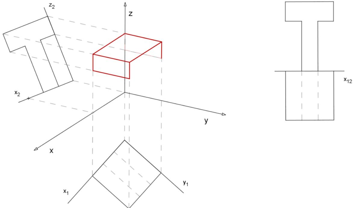
**Příklad:** Z daného půdorysu a nárysů sestrojte axonometrický obraz tělesa.
