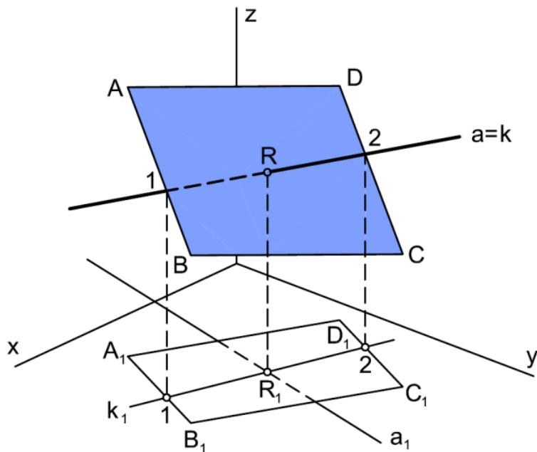
**Příklad:** Sestrojte průsečík přímky  $a$  s rovinou  $\sigma$  danou stopami a vyznačte viditelnost přímky  $a$ .
