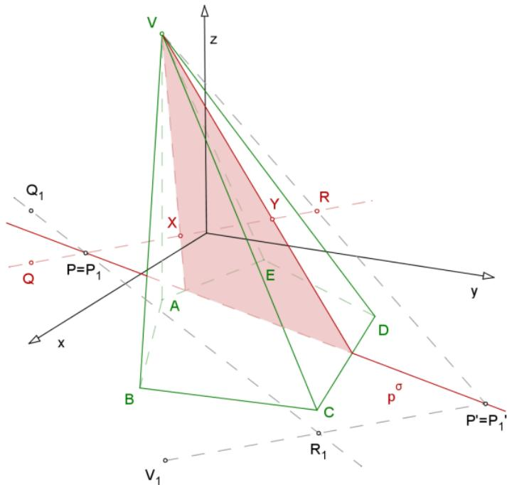
**Příklad:** Určete průsečík přímky  $QR$  s daným jehlanem, jehož podstava leží v půdorysně.
