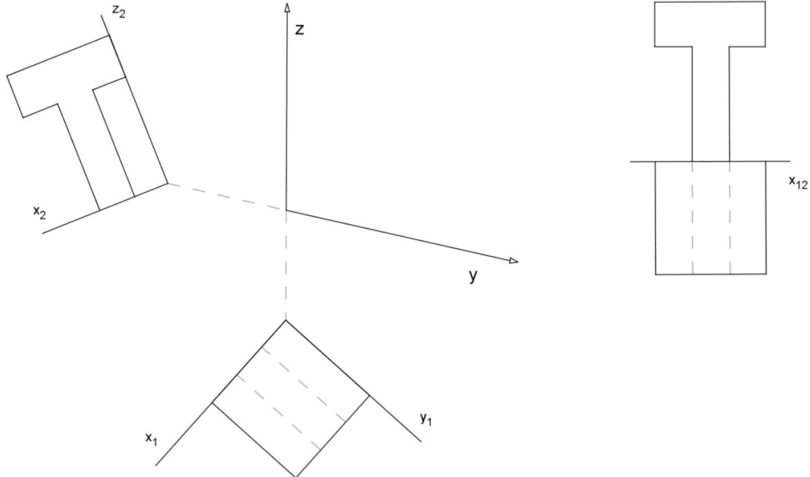
**Příklad:** Z daného půdorysu a nárysu sestrojte axonometrický obraz tělesa.
