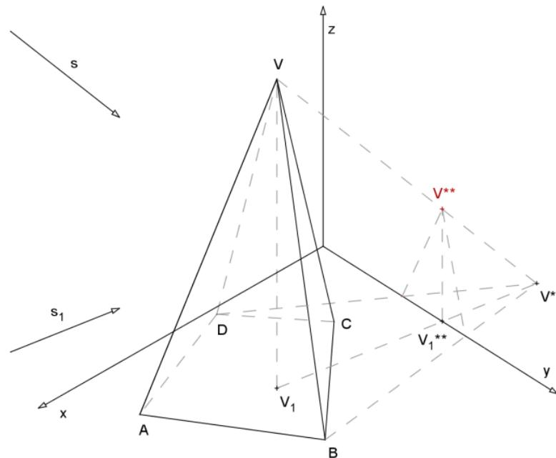
**Příklad:** Směrem s osvětlete daný jehlan, jehož dolní podstava leží v půdorysně, pomocné průmětny považujte za neprůhledné.
