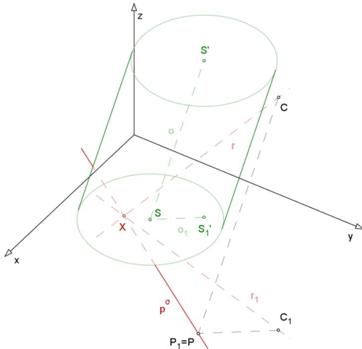
**Příklad:** Určete průsečíky přímky  $r$  s daným šikmým válcem (s dolní podstavou v půdorysně), určete viditelnost tělesa a přímky.
