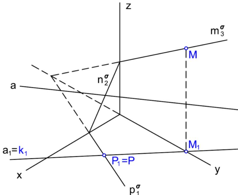
**Příklad:** Sestrojte průsečík přímky  $a$  s rovinou  $\sigma$  danou stopami a vyznačte viditelnost přímky  $a$ .
