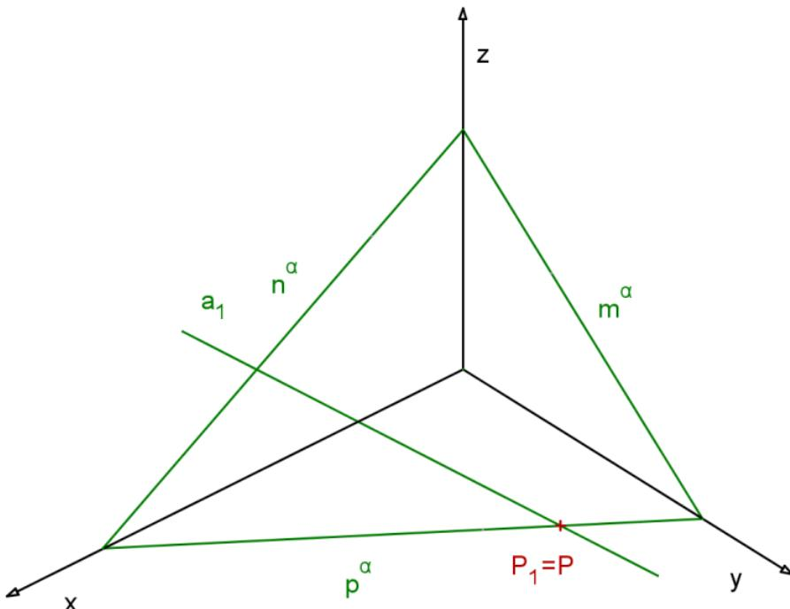
**Příklad:** Je dána rovina  $\alpha$  svými stopami. Sestrojte axonometrický průmět přímky  $a$ ,  $a \in \alpha$ , je-li dáno  $a_1$ .
