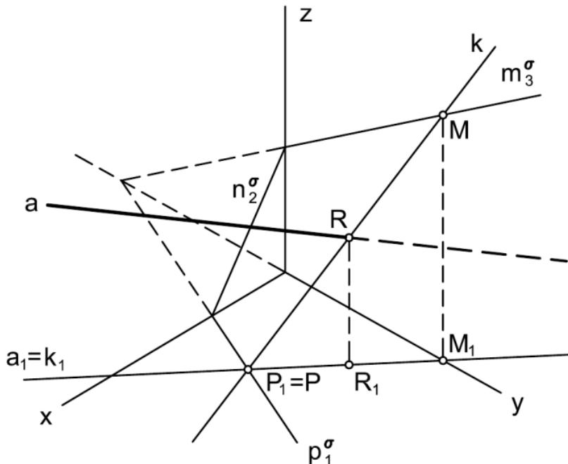
**Příklad:** Sestrojte průsečníci rovin  $\sigma$  a  $\varrho$ , které jsou dány svými stopami.
