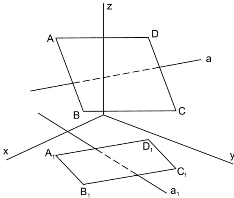
**Příklad:** Sestrojte průsečík přímky  $a$  s rovnoběžníkem  $ABCD$ . Vyznačte viditelnost přímky  $a$  vzhledem k rovnoběžníku.
