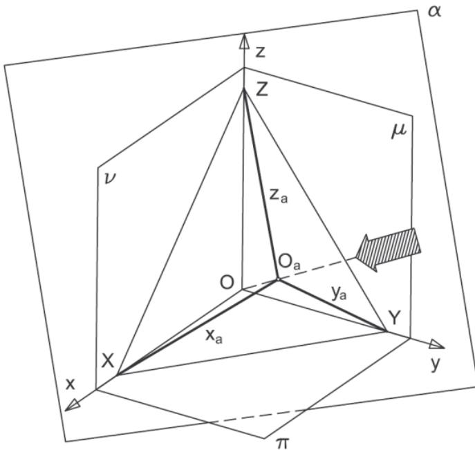
objekty v prostoru promítáme do roviny  $\alpha$  směrem s (různoběžným s rovinou  $\alpha$ )
