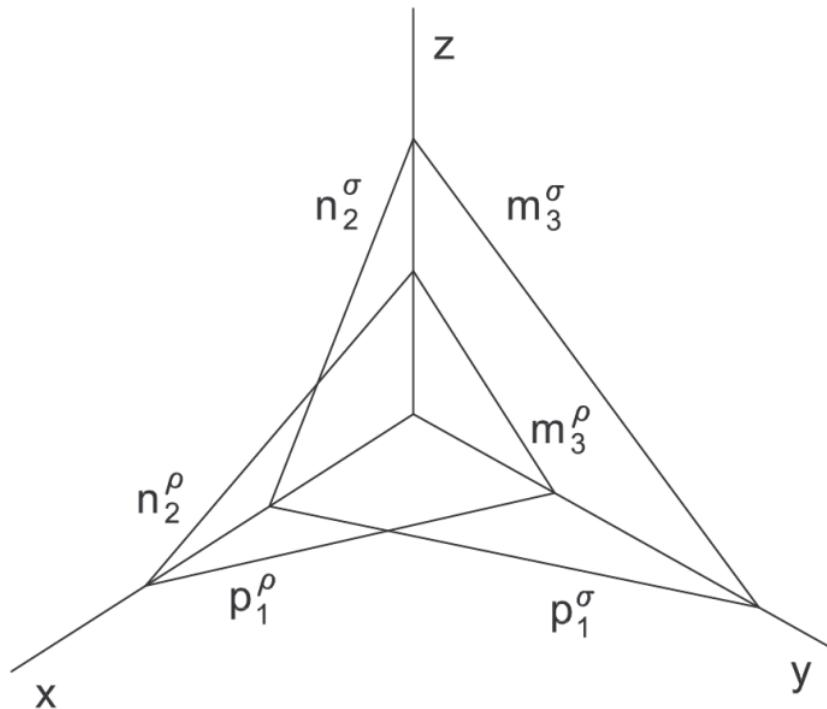
**Příklad:** Sestrojte průsečníci rovin  $\sigma$  a  $\varrho$ , které jsou dány svými stopami.
