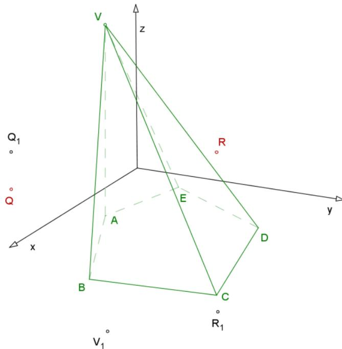
**Příklad:** Určete průsečík přímky  $QR$  s daným jehlanem, jehož podstava leží v půdorysně.
