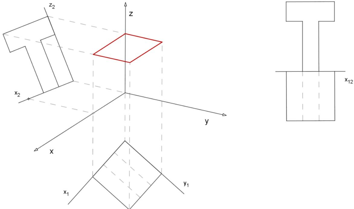
**Příklad:** Z daného půdorysu a nárysу sestrojte axonometrický obraz tělesa.
