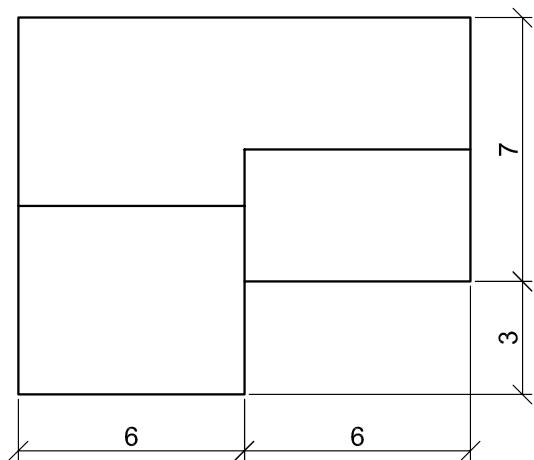
Perspektivu si zadejte podle následujícího náčrtu. Rýsujte na A4 naležato, hlavní vertikálu volte uprostřed stránky, aby oba úběžníky vyšly na papír. Použijte měřítko 1 : 100.
