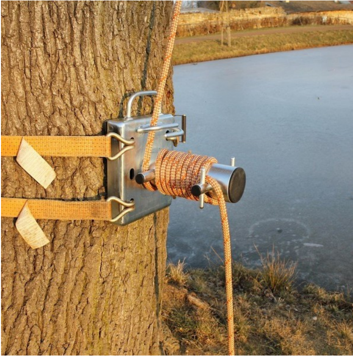
Obrázek 6: Třecí brzda jako spouštěcí buben. Dostatečné obtocení lana okolo tyče způsobí, že s malou námahou udržíme obrovskou sílu. Zdroj: https://www.skyman.cz/nabidka/arboristika/spousteni-bremen/bubny-a-kotvy/spousteci-buben-tu100-2-popruhy-2958.html
