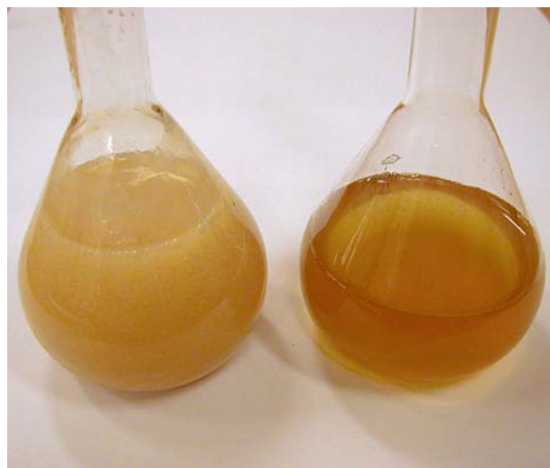
Obr. 1 – Vzorky medu v různé fázi zpracování pro vyhodnocení optické aktivity cukrů v medu (vlevo vzorek po sražení roztoky Carrez I a II a vpravo vzorek již čirý zfiltrovaný zbavený bílkoviny a po ustálení poměru alfa a beta anomerů – mutarotaci)
