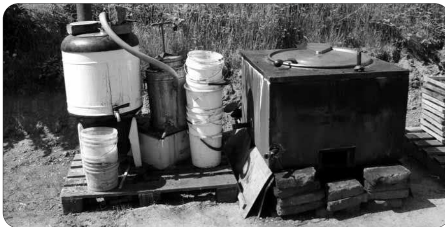
Kotel vhodný k desinfekci úlů (nástavků) horkým parafínem
